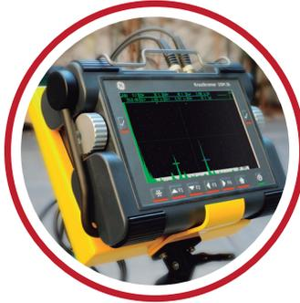
Soporte para equipo detector de fallas USM 36.
