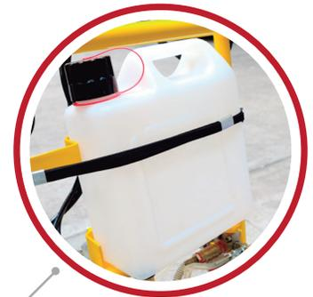
Depósito de agua (5L) con una manguera acoplada y con alimentación ajustable para los transductores.
