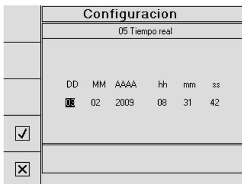
El parámetro **DD** está marcado y puede ser modificado con el teclado numérico o bien con las teclas ◀ y ▶.
