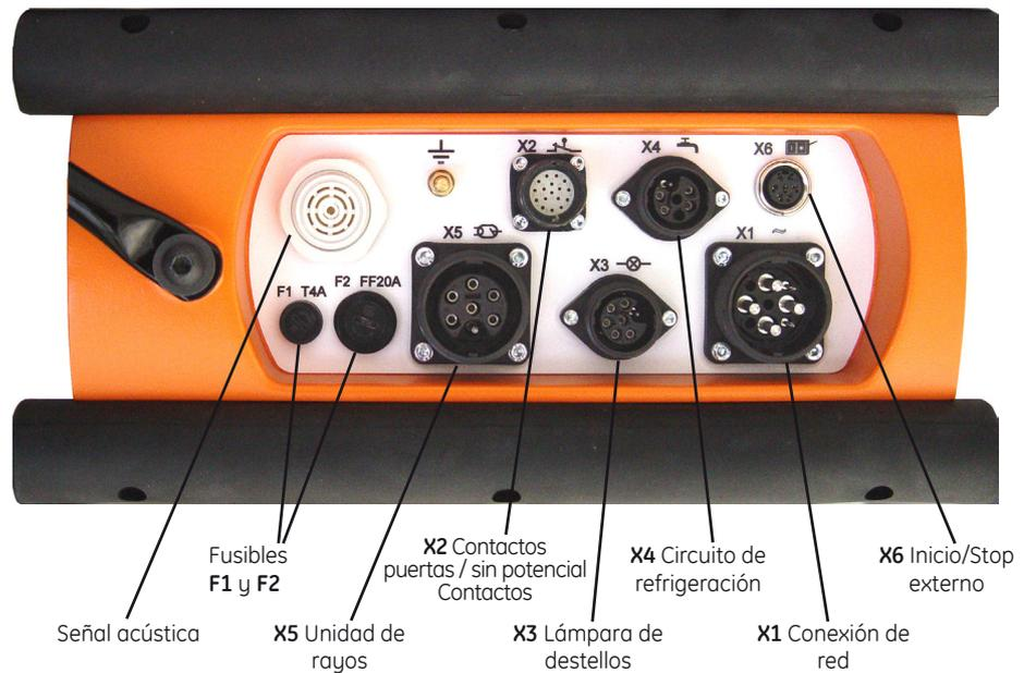
Fig. 5 - Placa de conectores de la unidad de mando digital **ERESCO MF4 control** (sin tapa, sin agarre)
