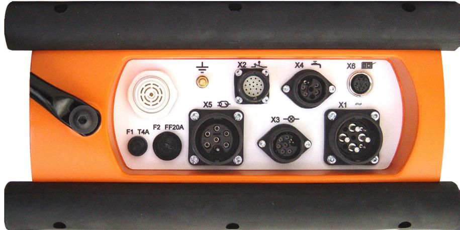
Fig. 7 - Placa de conectores de la unidad de mando digital **ERESCO MF4 control**
