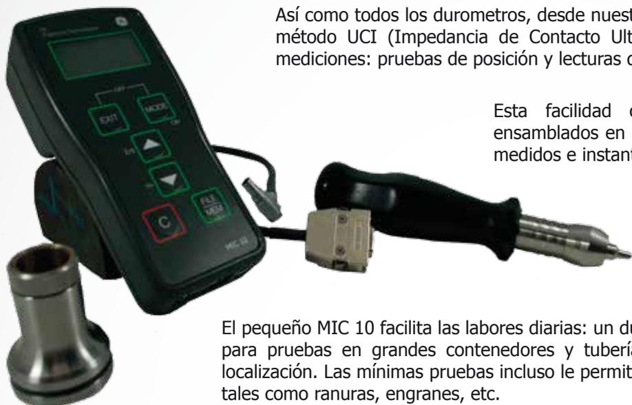
El pequeño MIC 10 facilita las labores diarias: un durometro que puede considerar cualquier restricción para pruebas en grandes contenedores y tuberías o para pruebas de componentes en cualquier localización. Las mínimas pruebas incluso le permiten hacer mediciones en posiciones de difícil acceso, tales como ranuras, engranes, etc.
