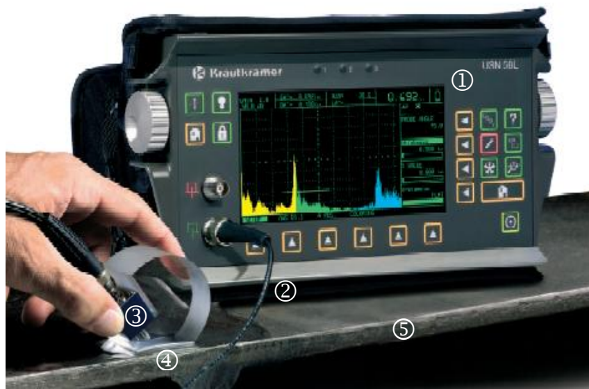
Figura No. 1: Sistema de Inspección Ultrasónica
