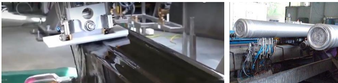
Figura No. 59: Método de acoplamiento con dispositivo de burbujeo
