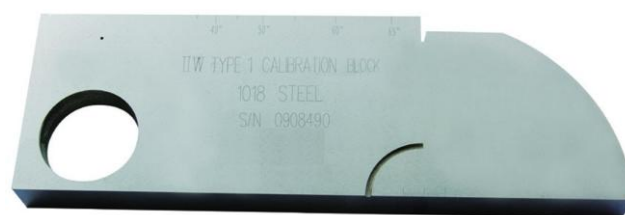
Figura No. 84: Bloque de referencia de IIW Tipo US-1 (AWS D1.1 y ASTM E 164)
