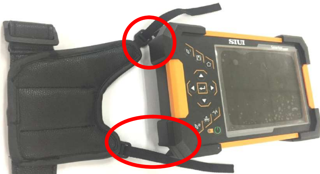
Fig. 1-10 Cómo ensamblar las correas
