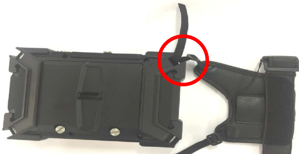
Fig. 1-11 Cómo ensamblar las correas
